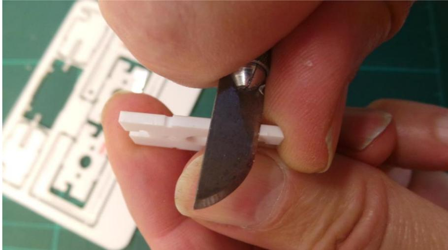
Les tenons qui viennent d'être coupés se trouvent souvent sur des faces d'appui et de positionnement des pièces, il faut donc les araser totalement avec une lame bien affûtée de couteau de modéliste ou de cutter.
