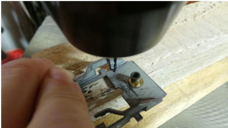
Tarauder les trous de fixation avec un taraud M2.
