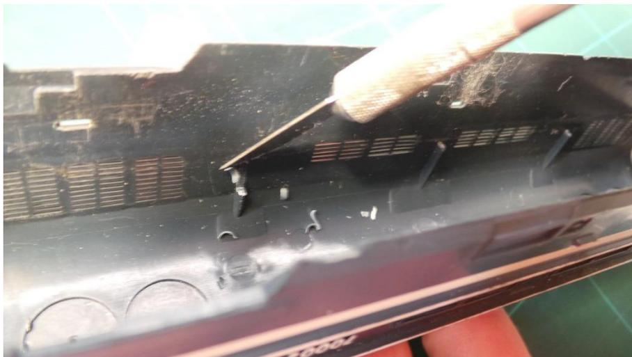
La carrosserie doit maintenant s'emboîter parfaitement dans le châssis.
