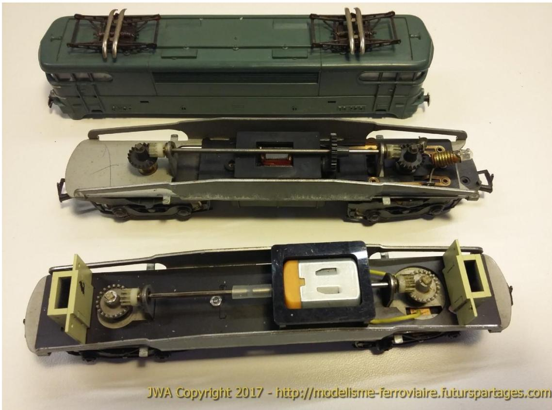
*1 Vue d'ensemble de la nouvelle motorisation et comparaison avec la motorisation d'origine.*
