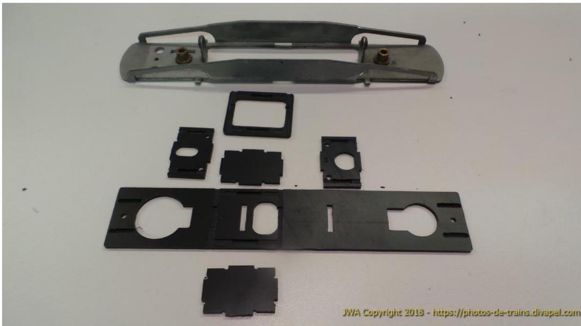
*8 Les 6 pièces du support moteur disposées dans leur sens de montage.*
