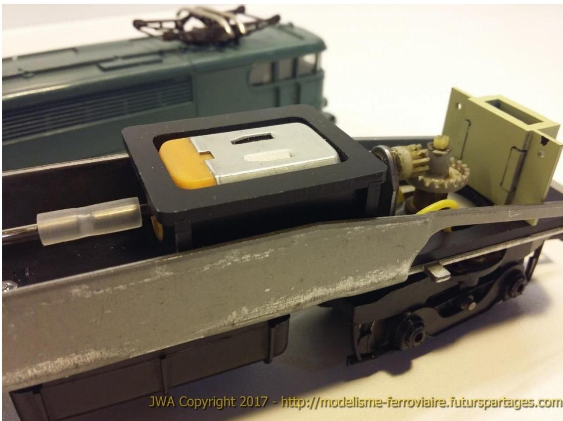
*2 Vue de détail sur le manchon de raccordement de l'arbre de transmission. Le manchon est en silicone, ce qui lui garantit une excellente souplesse et une grande durée de vie. A noter les cloisons de séparation pour la cabine.*
