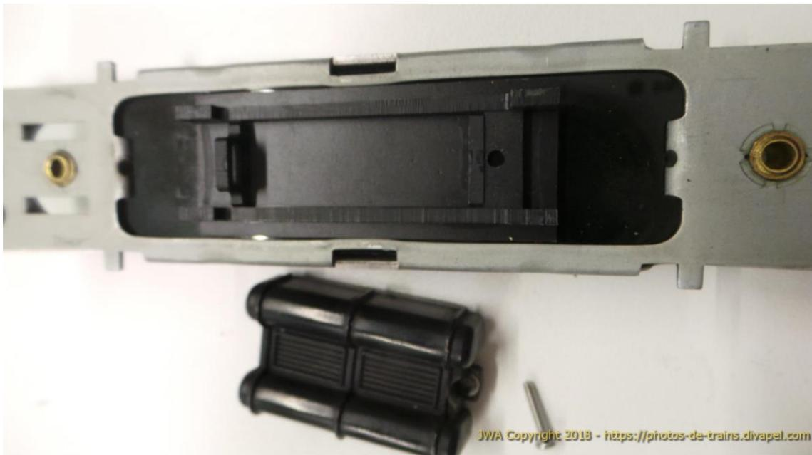
*16 Le perçage pour la vis de fixation des réservoirs d'air est traversante une fois le dessous de châssis assemblé sur le support moteur (les trous prépercés sont alignés et servent de détrompeur.*
