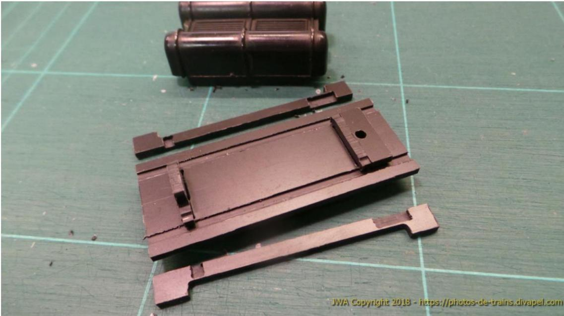
12 Présentation à blanc des traverses de centrage positionnées dans le bon sens (la traverse avec l'ouverture oblongue à l'opposé du trou pour la vis de fixation).
