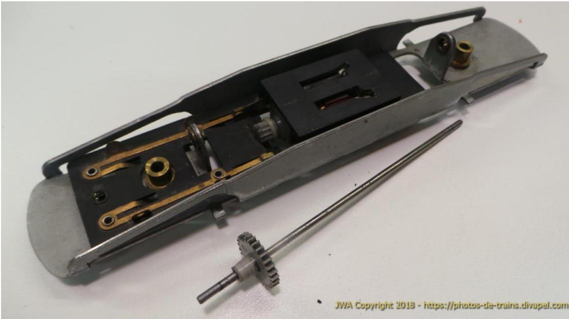
6 A l'aide d'un foret de 3mm environ, faire sauter le rivet qui fixe le boîtier du moteur sur le châssis.
